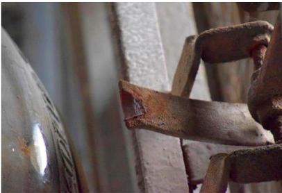
gerissen, und bei der Wartung wurden dann weitere Schäden festgestellt. Wie man auf dem Bild sieht, ist die Blattfeder defekt. Das führt zu Schäden an der Glocke (heller Punkt). Weitere Mängel wur-
